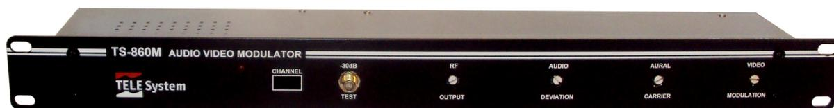
Este modulador se construye con filtro SAW para proporcionar un rechazo de banda lateral y espurios no deseados ofreciendo un alto rendimiento y confiabilidad.
