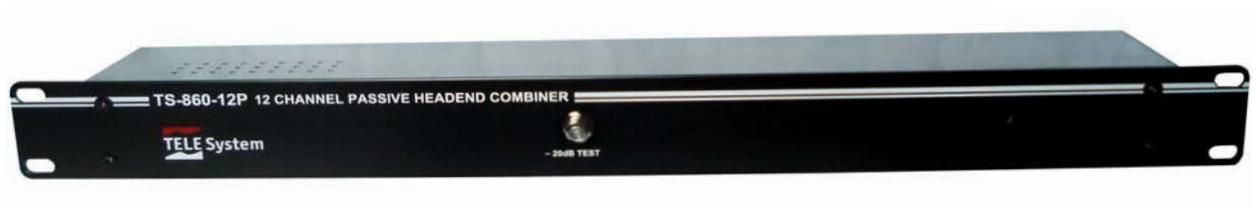
El TS-860-12P es un combinador de calidad CATV empleando los principios de diseño direccional de acoplamiento para obtener un alto aislamiento entre los puertos de entrada. El TS-860-12P proporciona un método conveniente de combinar las salidas de los moduladores, amplificadores y procesadores de banda. Normalmente, la salida del combinador se dirige a una etapa de amplificación de lanzamiento de la cabecera.
