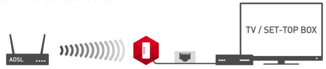
Wi-lly 0.1 Plus agisce come client connettendosi alla rete WiFi domestica e "condivide" la connessione internet con un dispositivo embedded (come TV, set-top box o ricevitore digitale) collegato via porta Ethernet (con il cavo Ethernet in dotazione).
