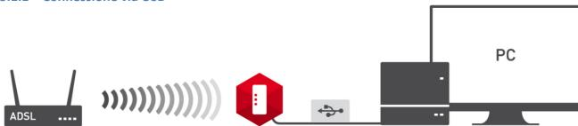
Wi-lly 0.1 Plus agisce come client connettendosi alla rete WiFi domestica e "condivide" la connessione internet con un PC (sistema operativo Windows, MAC OS o Linux) tramite il connettore microUSB. Wi-lly non solo si alimenta dalla porta USB ma può estendere la connessione internet al PC connesso.
