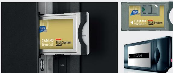
Lo slot CI+ offre la massima compatibilità con le CAM TELE System certificate tivùsat e la CAM HD per la Pay TV Digitale Terrestre per ampliare l'esperienza e la qualità di visione. Il caricamento dei canali satellitari in modalità "default", prevede come predefiniti la lista canali italiana in modalità gerarchica HD.
