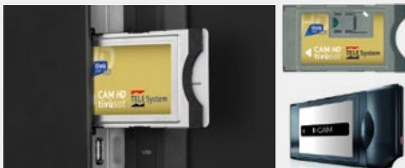
Lo slot CI+ offre la massima compatibilità con le CAM HD per accedere ai contenuti pay del digitale terrestre e con la CAM certificate tivùsat per ampliare l'esperienza e la qualità di visione.
