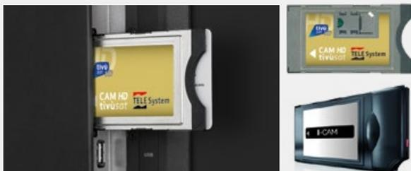
Lo slot CI+ offre la massima compatibilità con le CAM certificate tivùsat e Mediaset Premium per ampliare l'esperienza e la qualità di visione.
