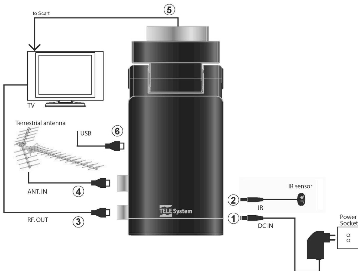
1. **DC IN** Ingresso per l'alimentatore AC/DC in dotazione
