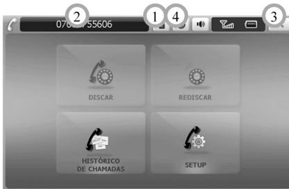
1. Pressione o ícone para endereçar a ligação para o telefone emparelhado interrompendo a função Viva Voz. O ícone muda conforme indicado abaixo.
